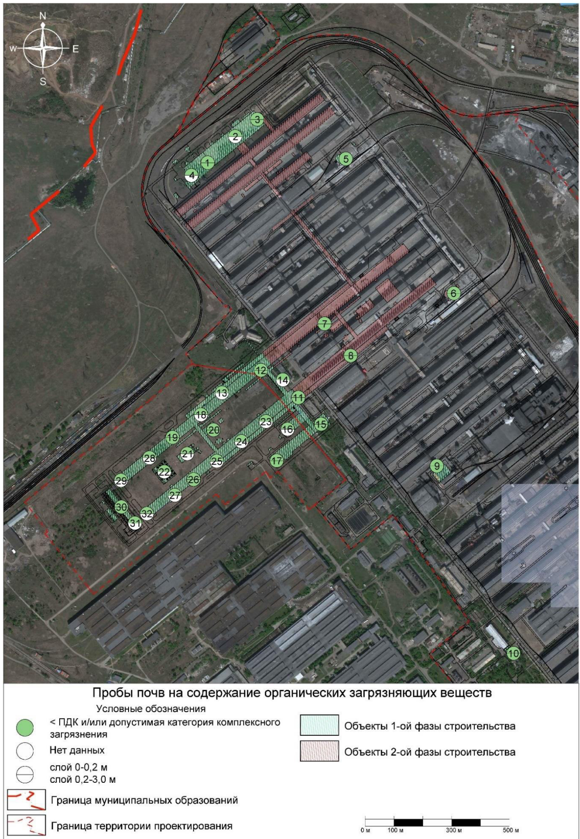
Рисунок 3.2.3.2-3. Карта-схема загрязнения ТПО и грунтов производственной площадки АО «РУСАЛ Красноярск» органическими загрязняющими веществами
